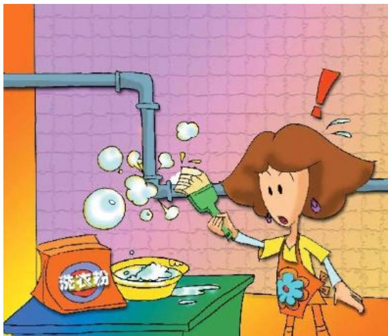
定期检查胶管是否漏气，可用肥皂水刷在管道接口等处，如有气泡冒出，证明该处漏气，禁止用明火查找漏气点。
